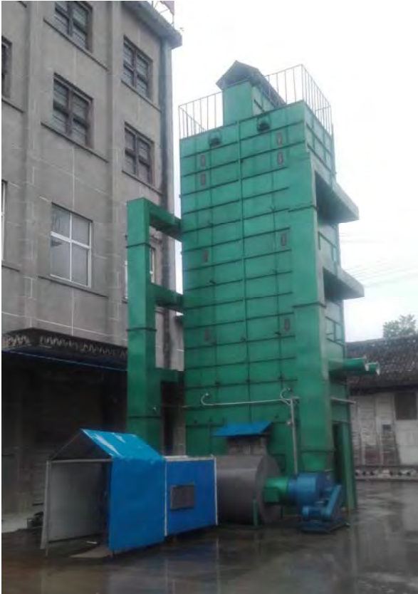
新产品-高水分稻谷双塔串联式干燥机 1
