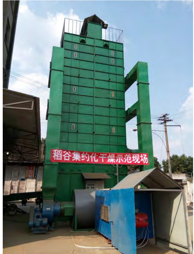
新产品-高水分稻谷双塔串联式干燥机 2
