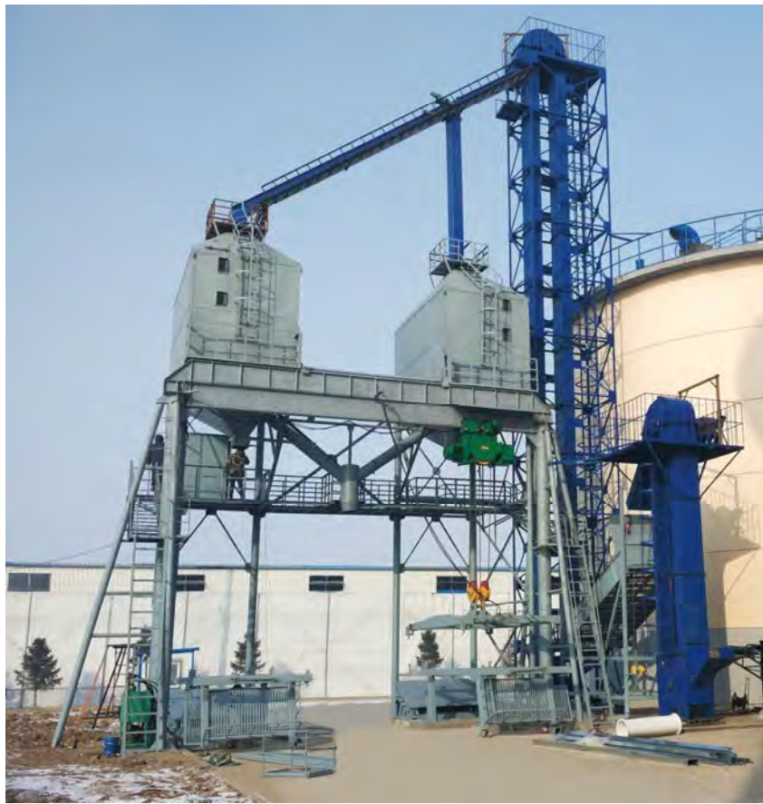
固定式散粮集装箱装卸装置
