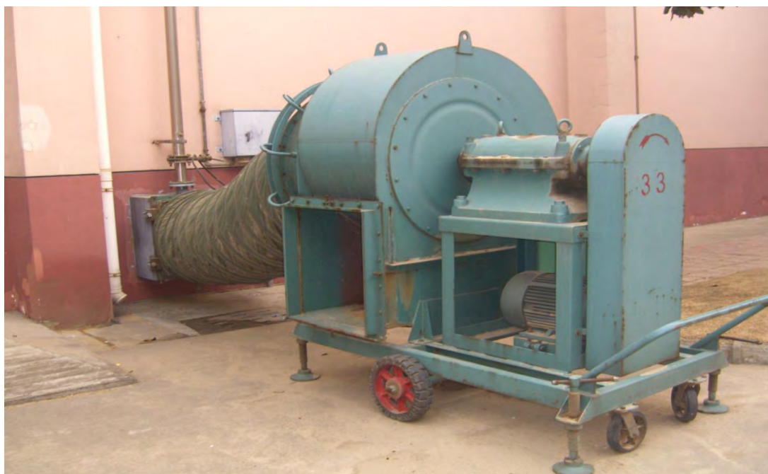
秋冬季节利用风机通风降低基础粮温，形成冷芯
