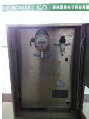
XS-C1J 多功能粮情检测系统分机（内部）
