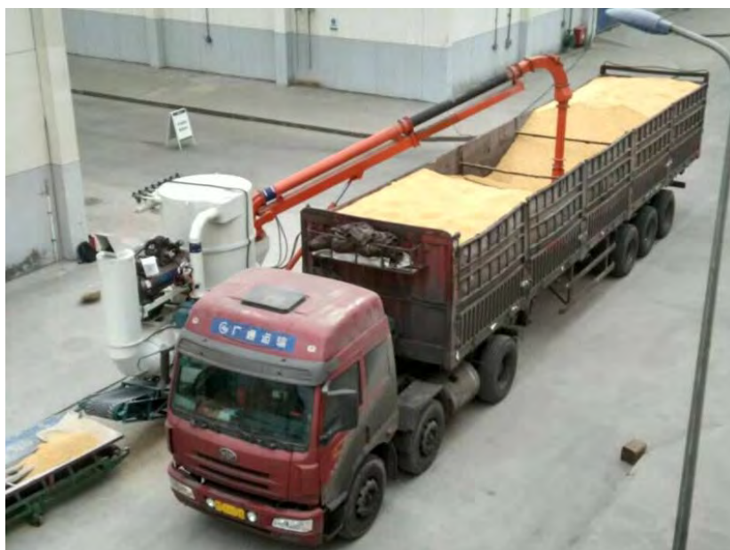
XYL50 型轮式移动吸粮机在陕西省商洛直属库工作现场
