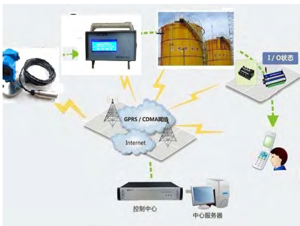
图 3 油库罐群液位液温测量系统
